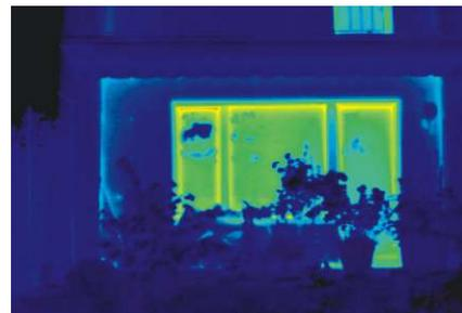
Foto termografica eseguita dopo il montaggio delle finestre nel sistema Corona CT 70 conferma alti benefici energetici come risultato dell'investimento eseguito. Le perdite precedenti sono state quasi totalmente eliminate.
