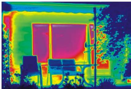
Foto termografica dimostra chiaramente, gli spazi attraverso quali energia consumata per riscaldamento della casa esce fuori di casa. Colore rosso significa caldo cioè le perdite di energia.
